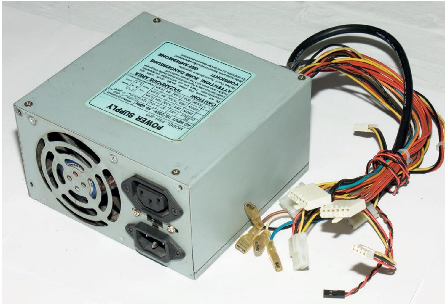
Figura 3.18. Fuente de alimentación de tipo AT.
